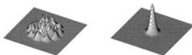
Abbildung 3: Typischer Multi-Modus (links) gegenüber dem präzisen Supergaußschen ZEISS Strahlprofil (rechts)
